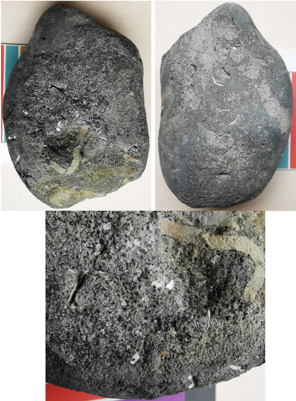
grijze Paniseliaanse zandsteen met helder kiezelcement met afwisseling tussen middelmatig en matig-grof tot zelf grofkorrelig zand, glauconiethoudend tot ca 10% in dezelfde korrelgrootte als de kwarts, lokaal wat kleiiger matrix (naast het kiezelcement), en met verspreide schelpfragmenten, vooral in de grofzandige en meer poreuze delen; 7x5x2.3 cm met platte onderkant
