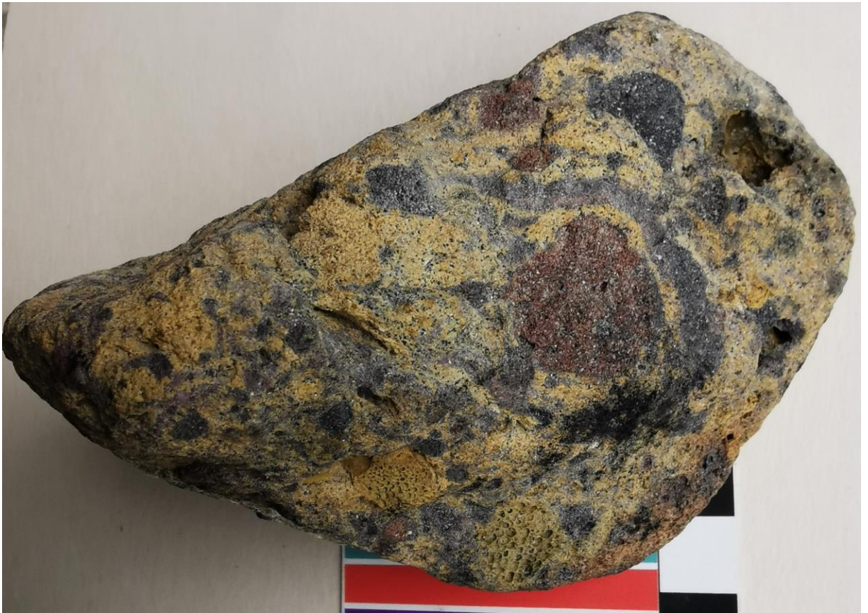
gele polderbaksteen, uitwendig rood geoxideerd, zonair opgebouwd uit zones met grote bellen (zie onderaan) afgewisseld met fijnere korrel en meer metallische glans omheen roodverbrande kernen, in driehoekige licht afgeronde vorm 8.5x6x4 cm
