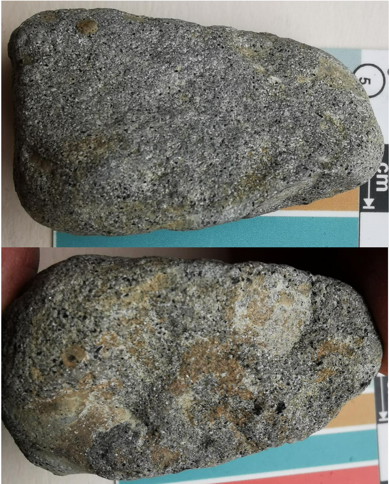
Groengrijze matig-fijne glauconietrijke (>10% ook matig-grove zwarte glauconiet) harde Ieperiaanse veldsteen met wit kiezelcement in gebroken licht afgerond blokje 4.5x2.5x2.3 cm
